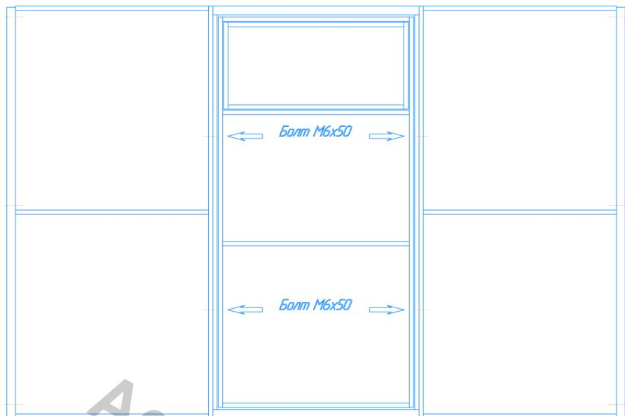
Соедините винтами M6×70 мм, шайбами М6, гайками М6 торец со стартовыми прямыми согласно просверленных в торце отверстий.
