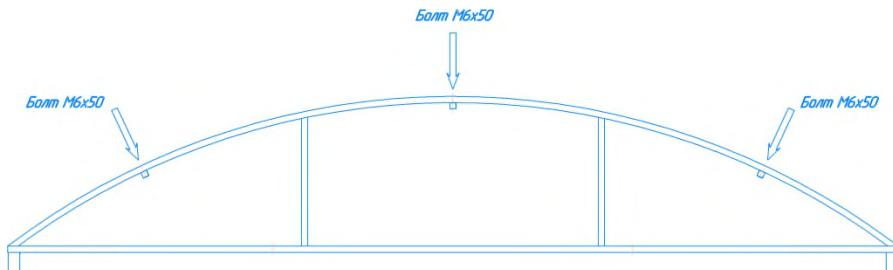
Соедините винтами M6×50 мм, шайбами M6, гайками M6 торцевые панели с дверным блоком согласно просверленныххв отверстий.
