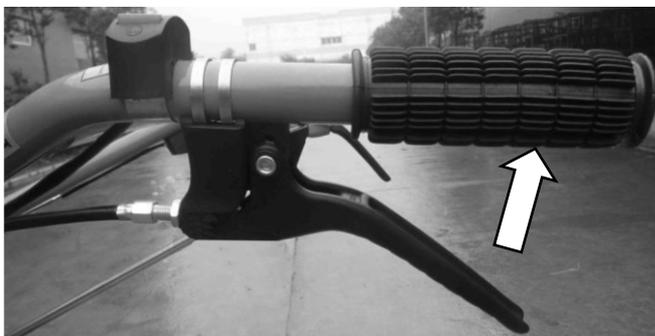
3. Прижмите ручку управления сцеплением к рукоятке. В таком положении связь между двигателем и коробкой передач разрывается и становится возможным переключение передач. **ВАЖНО!!!** Всегда перед переключением передач выжимайте ручку управления сцеплением. Отпускайте рычаг медленно и плавно. Никогда не «кидайте» его, это сократит ресурс коробки передач и редуктора
