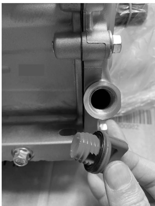
4. Заливка масла в двигатель.
