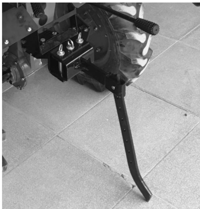
Монтаж кронштейна сошника и сошника. По прибытии на место культивирования отрегулируйте заглубление сошника в зависимости от плотности почв. При работе с мягкими почвами устанавливайте сошник в крайнее нижнее положение, при работе с твердыми почвами в крайнее верхнее. Проводить культивирование без установленного сошника ЗАПРЕЩЕНО!!!
