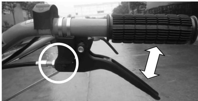
Выберите люфты в тросиках сцепления и газа. (они должны быть примерно 2-3 мм). Для этого используйте резьбовые втулки с контргайками на концах тросов (для троса газа может быть в середине). Выжим сцепления должен быть четкий, Вы должны чувствовать, что преодолеваете сопротивление пружины механизма сцепления.
