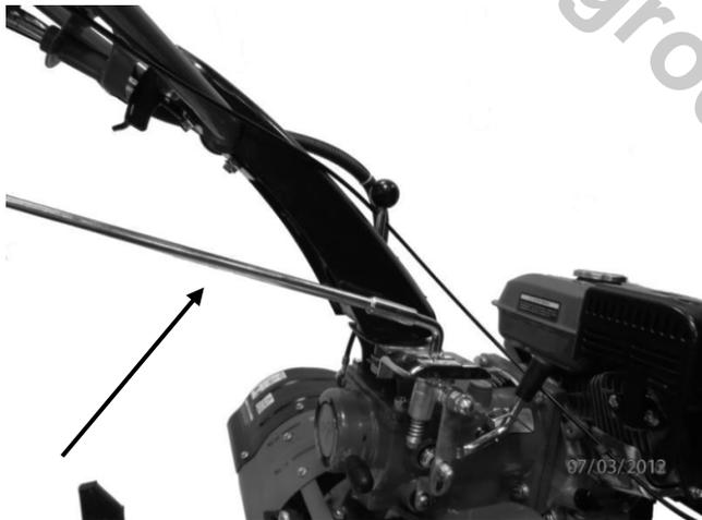
Монтаж удлинителя рычага переключения передач.
