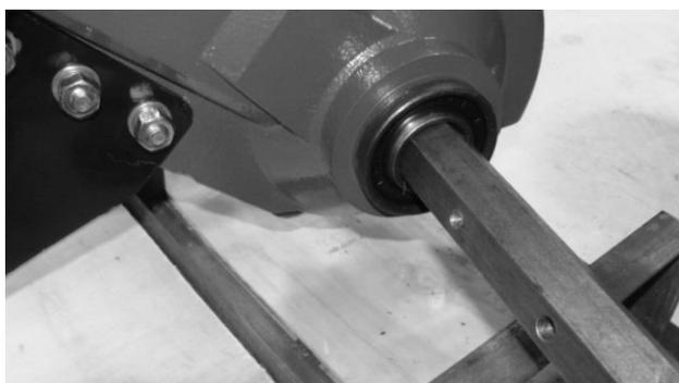
Спозиционируйте выходную ось посередине редуктора .
