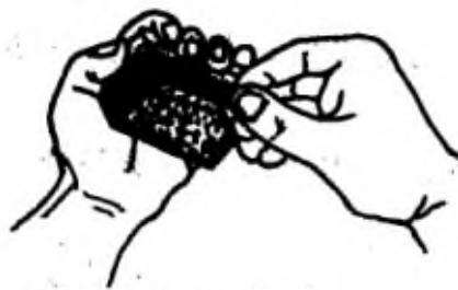
Рис. 20 Удалите нагар с игольчатого клапана
