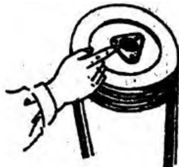
Рис. 13 Смазка зубчатой муфты
