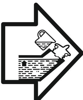
Выкрутите пробку (как показано на рисунке) из двигателя. Заливайте свежее чистое масло в двигатель до горловины маслозаливного отверстия.
