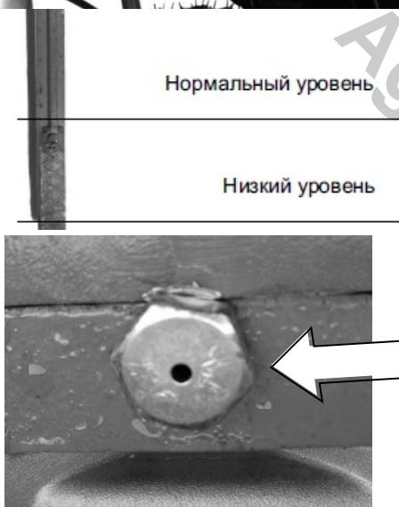
В моделях оснащенных сапуном, возможен сбор излишков масла во время эксплуатации мотокультиватора (не является поломкой).
