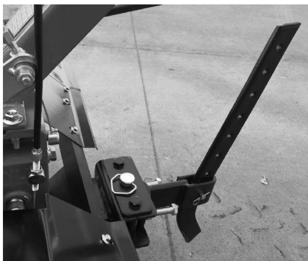
Монтаж кронштейна сошника и сошника. По прибытии на место культивирования отрегулируйте заглубление сошника в зависимости от плотности почв. При работе с мягкими почвами устанавливайте сошник в крайнее нижнее положение, при работе с твердыми почвами в крайнее верхнее. Проводить культивирование без установленного сошника ЗАПРЕЩЕНО!!!
