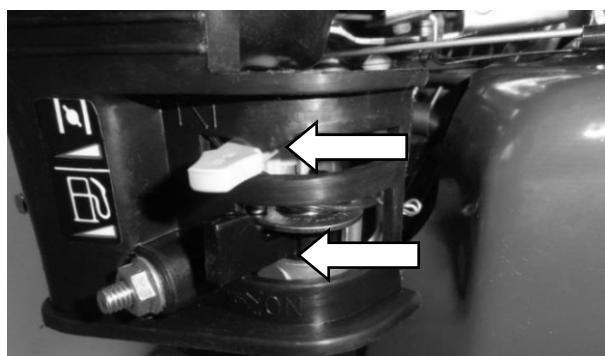
Для того, чтобы заглушить двигатель, нужно перевести ручку управления газом влево (минимальные обороты, как на рисунке), затем выключатель зажигания в положение OFF - выключено. После этого закройте топливный кран и воздушную заслонку .
