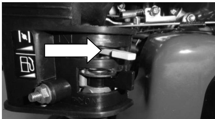
Двигатель должен заработать. В зависимости от температуры окружающей среды через 5-20 секунд двигатель начнет терять обороты и дымить. В этот момент нужно открыть воздушную заслонку (указана стрелкой на рисунке).
