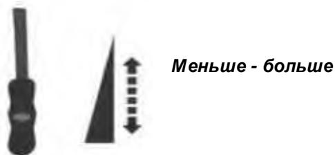
**Рисунок 3.8. Рычаг регулировки подачи топлива («ручной газ»)**
