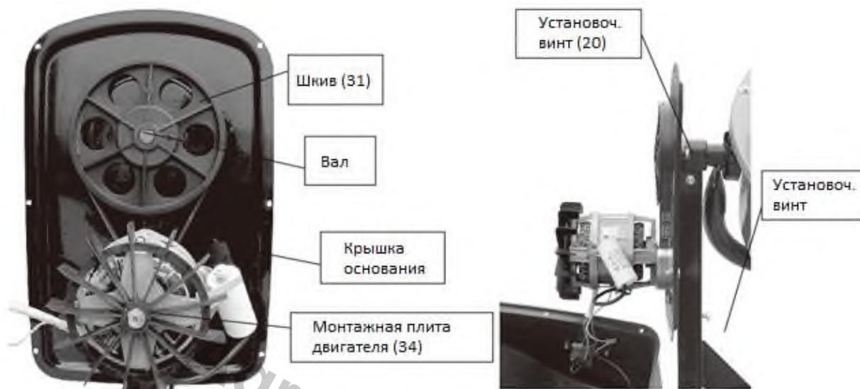
18. Присоедините монтажную плату электродвигателя (34) к внутренней крышке основания электродвигателя (33) с использованием болта с шестигранной головкой (20), установочной шайбы, шестигранной гайки и винта (49). Затяните настолько, чтобы плата не двигалась с места.
