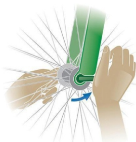
Эксцентриковый зажим колесных втулок
