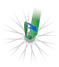
Эксцентриковый зажим колесных втулок
