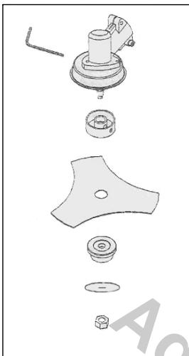
Установите режущий нож таким образом на ведомый диск, чтобы середина режущего ножа лежала точно на ведущем круге ведомого диска.
