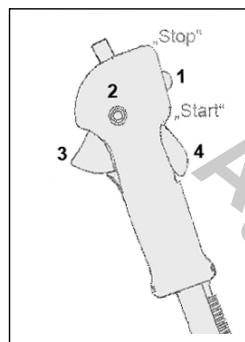
1. Установите выключатель зажигания в положение "Start".
